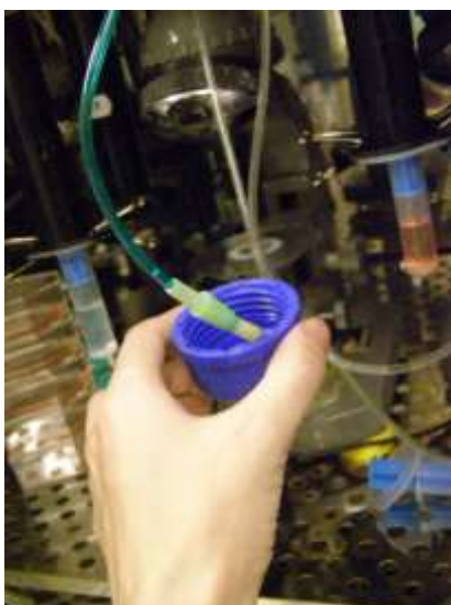
4. kép az elszívó ág átmosása 70%-os etanollal
